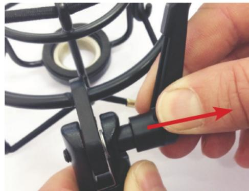
**3** そのような場合は、ショックマウント・コネクターを片方の手で持ち、もう片方の手でコネクターから引き抜きます（コイル状のバネがありますのでレバーは完全には抜けません）。レバーを引き抜きながら、反時計回りに回してください。
