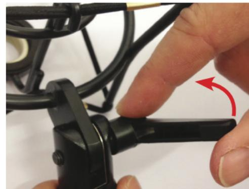
**4** レバーがスプリングで元の位置に戻り、ショックマウントを締め付けるために時計回りに回転させるスペースができます。
